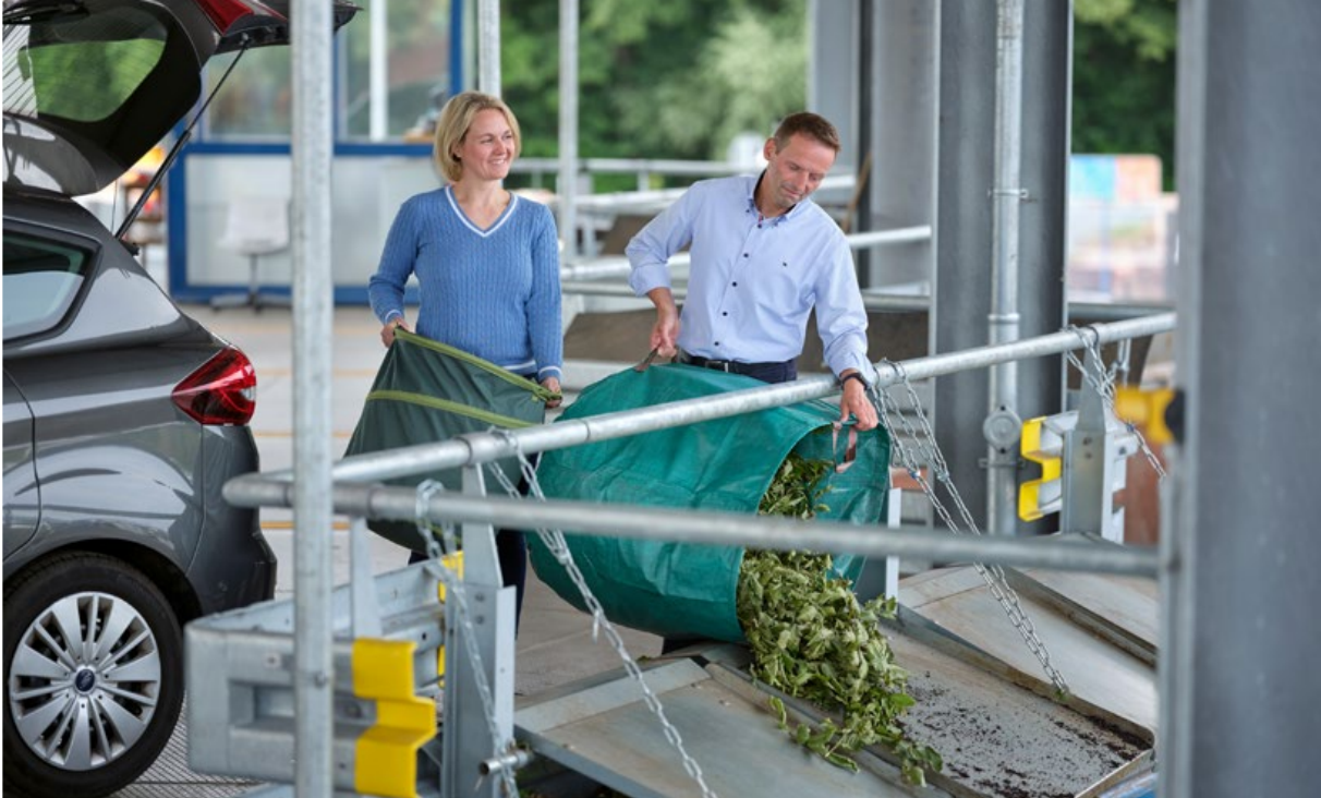
Abbildung 2: Anordnung der Rutschen zum einfachen Handling von Grünabfällen
